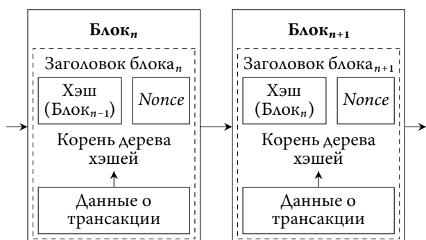
Рисунок 1 – Схема взаимодействия блоков в блокчейн
